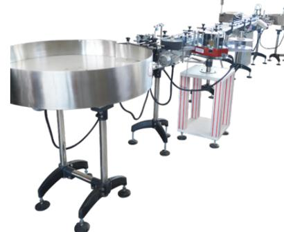
Линия предназначена для группового дозирования продукта в тару и этикетировки самоклеящимися лейблами. Оборудование широко применяется для розлива клеточных соков, витаминных концентратов, экстрактов, масляно-эфирных комплексов и других биодобавок, а также растительных масел и других пищевых продуктов. Также установка может использоваться в фармацевтической, ветеринарной и косметической промышленности.
