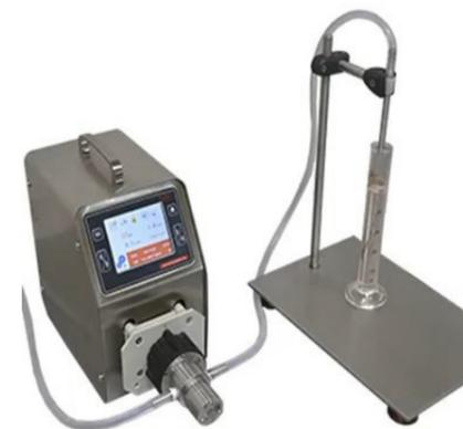
Предназначен для фасовки продуктов различной густоты и степени вязкости в стеклянную и пластиковую тару. Изделие применяется на производственных площадках предприятий, реализующих процесс фасовки растительных масел и других пищевых продуктов, фармацевтических препаратов, косметических средств, чистящих средств, товаров автомобильной химии, тосолов и широкого спектра других товаров.
