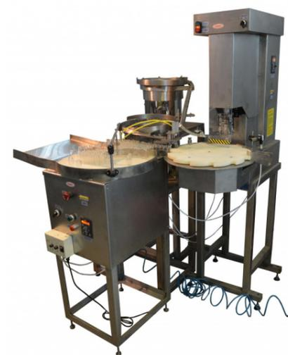
Предназначен для закатки стеклянных флаконов алюминиевыми гладкими колпачками с диаметром от 13 до 45 мм. Устройство применяется в медицинских лабораториях, научных центрах, исследовательских институтах, на станциях переливания крови и скорой помощи, в больницах и аптеках при приготовлении лекарственных препаратов и их компонентов в стеклянных флаконах.
