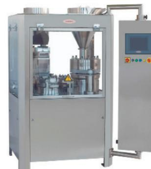
Модель полностью автоматизирует процессы разъединения, ориентации, наполнения и закрытия капсул, обеспечивая сокращение трудозатрат и увеличение объемов выпуска продукции. Оборудование оснащено системой управления с сенсорной панелью, а также системой отбраковки поврежденных капсул.
