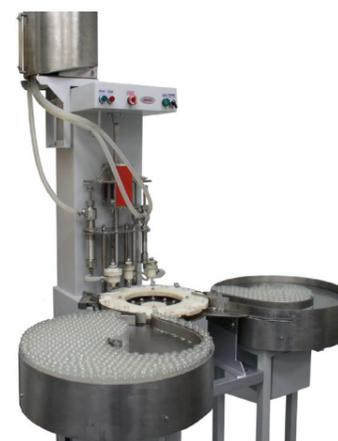
Предназначен для дозированной подачи жидких продуктов в стеклянные флаконы в составе автоматической линии. Изделие может применяться в медицинских учреждениях. При изготовлении установки были использованы наши собственные разработки. Оборудование соответствует требованиям GMP.
