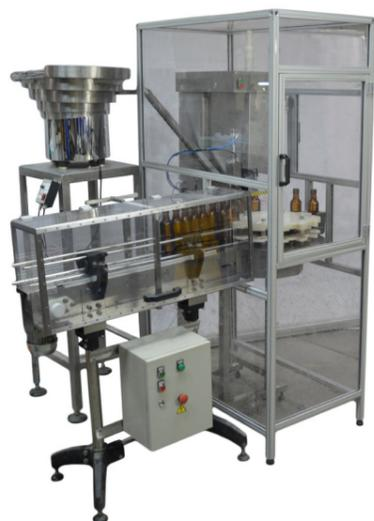
Предназначен для укупорки стеклянных флаконов высотой 31-32 мм алюминиевыми винтовыми колпачками под накатку резьбы. Такой тип закатки используется при производстве пищевых продуктов (растительных масел, кетчупов, сока, молока и других) и медицинских средств (растворов, сиропов, суспензий и т. д.).
