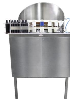
Оборудование предназначено для ориентирования ПЭТ-тары в положение, необходимое для качественной реализации процесса последующего розлива во флаконы. Машина применяется в составе комплексных линий розлива лекарственных препаратов на фармацевтических и ветеринарных производствах, а также на предприятиях, разливающих косметическую продукцию в пластиковые флаконы.
