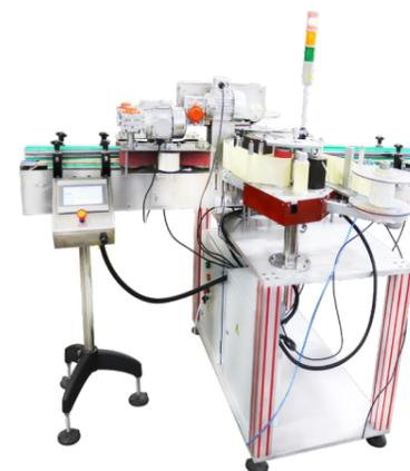
Предназначена для нанесения этикеток с датой на самоклеящейся основе на тару с последующей обкаткой.
