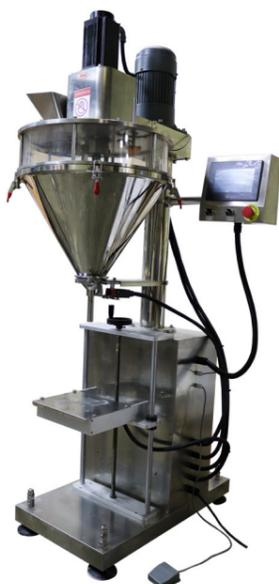
Предназначен для весового дозирования сыпучих продуктов в тару. Оборудование используется в различных сегментах промышленности для фасовки специй, круп, чая, орехов, снежков, сухого молока, талька, фармацевтических и ветеринарных порошковых препаратов.
