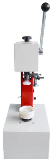
Применяется для быстрого и герметичного закручивания стеклянных флаконов различной высоты (до 180 мм), предназначенных для хранения лекарственных средств широкого спектра, ветеринарных препаратов и парфюмерной продукции.
