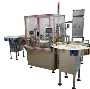
Моноблок МЗ-400ЕД предназначен для реализации процессов розлива, укупорки, этикетировки и маркировки продукции, выпускаемой большими партиями. Машина разработана для компаний фармацевтического и косметического профиля, реализующих производство эфирных масел и спиртосодержащей продукции. Кроме того, установка может эксплуатироваться на предприятиях пищевой отрасли для упаковки подсолнечного масла, алкогольных и безалкогольных напитков и ряда других продуктов.
