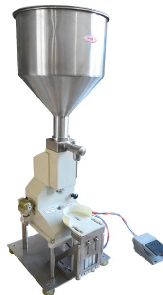
Усовершенствованная модификация пневматического дозатора МДР ручного типа представлена моделью с подъемным столом для перемещения тары. Устройство автоматически поднимает флакон, точно позиционируя его под дозирующим соплом. При этом тара надежно фиксируется в сменном подстаканнике, что исключает риск ее падения. Изменение положения стола регулируется нажатием педали.
