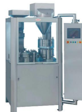
Машина обеспечивает равномерное наполнение желатиновых капсул сухими порошкообразными и гранулированными составами, производит их последующую укупорку и выгрузку.
