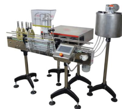
Перистальтический дозатор МДП-200Л — это высокопроизводительная дозирующая установка, встраиваемая в автоматические линии розлива. Розлив продукта осуществляется одновременно из 4 сопел, что обеспечивает более высокую производительность в сравнении с другими аналогичными моделями. В зависимости от производственных задач насосы могут работать в режиме перекачивания или наполнения.
