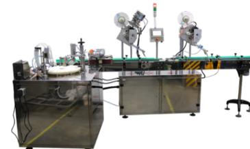
Многофункциональный комплекс розлива, укупорки и этикетировки, разработанный специально для упаковки антисептических спреев для рук в компактные плоские контейнеры с диспенсерами. Установка предназначена для дозирования жидких продуктов в плоские контейнеры, забивки и двустороннего этикетирования. Оборудование может использоваться на участках упаковки санитайзеров, антисептиков, косметических гелей, жидкого мыла, БАДов и другой продукции.
