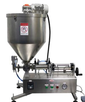
Предназначен для дозированной подачи жидких и пастообразных продуктов во флаконы. Изделие может применяться в пищевом и химическом производствах.
