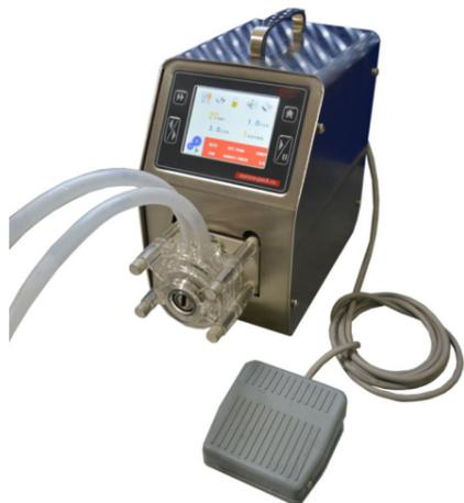
Конструкция обеспечивает закрытый поток продукта от резервуара с продуктом до кончика наполняющего сопла. Дозатор не требует чистки при смене единичной загрузки продукта, поскольку полная сборка трубок заменяется в конце каждого производственного цикла, таким образом исключается возможность перекрестной контаминации. Смена продукта производится менее чем за одну минуту. Объем выдаваемой дозы задается на электронном табло.
