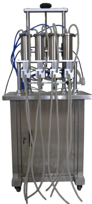
Предназначен для дозированной подачи парфюма (духов) на спиртовой или масляной основе в стеклянные флаконы. Изделие может применяться в парфюмерной отрасли. Конструктивно данный дозатор отличается от других системой розлива. Она является совмещенной - дозирование жидкости по объему и отсечка избытка продукта/пены по уровню наружного сопла.
