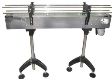
Оборудование предназначен для перемещения тары между различными участками технологической линии (мойки, розлива, укупорки, этикетирования и других). Установка широко востребована промышленными предприятиями различного профиля и интегрируется в линии производства фармацевтических, ветеринарных, косметических средств, а также ряда продукции других отраслей.
