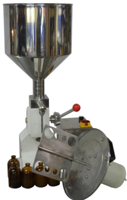
Дозатор предназначен для дозированной подачи жидких, средневязких, вязких и густых продуктов во флаконы объемом от 5 до 50 мл. Особенностью этого оборудования является наличие встроенного устройства перемешивания. Дополнительно оснащен предохранительной муфтой пружинного типа. Установка выполнена с объемным регулированием по наполнению и оснащена системой удаления «последней капли».
