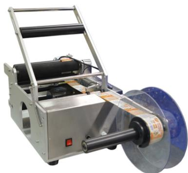
Предназначен для нанесения прозрачных, непрозрачных и матовых самоклеящихся этикеток на бутылки, флаконы, банки, шприцы и др. тару.
