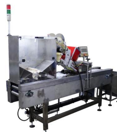
Предназначен для нанесения этикеток с датой на самоклеящейся основе на тару с последующей обкаткой. Установка применяется на производственных предприятиях косметической и химической отраслей промышленности.
