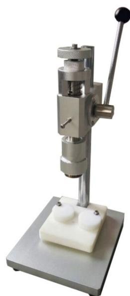
Предназначено для укупорки парфюмерных флаконов. Обжимает алюминиевые колпачки с пульверизатором из стекла с гладким горлом и наружным диаметром 12 - 22 мм.
