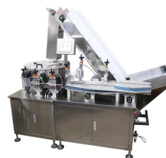
Установка ориентирования ОТ-400 выполняет позиционирование и подачу пластиковой тары на технологические участки упаковочной линии. Комплекс оснащен транспортером элеваторного типа, который выполняет загрузку флаконов из приемного бункера. Оборудование может быть интегрирована в системы фасовки и упаковки лекарственных препаратов, косметических средств, товаров бытовой и промышленной химии, пищевых и других продуктов.
