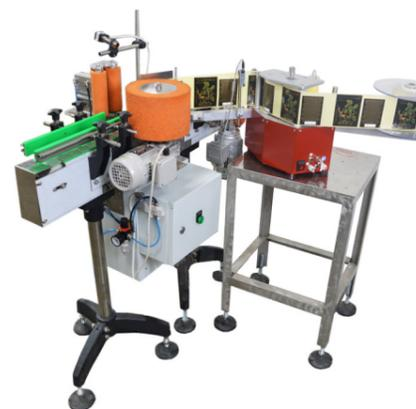
Предназначена для нанесения фронтальных этикеток и контрэтикеток на флаконы, бутылки и другую тару круглой формы.
