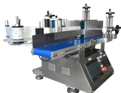
Предназначена для этикетировки цилиндрических флаконов и тары с плоскими поверхностями лейблами на самоклеящейся основе.
