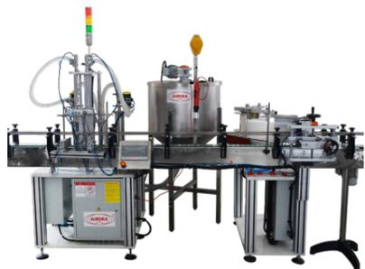
Линия выполняет высокоточную и деликатную фасовку агрессивных жидкостей в ПЭТ-флаконы и канистры объемом 50-1100 мл, укупорку закруткой с заданным моментом и этикетирование. Оборудование может использоваться для фасовки очистителей для канализационных труб, отбеливателей, белизны, профессиональных средств для уборки и других товаров бытовой химии.
