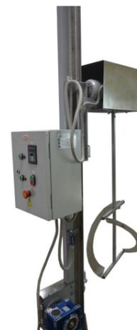
Устройство перемешивания представляет собой передвижную стойку с подъемной платформой. Мешалка предназначена для перемешивания различных жидкостей с вязкостью близкой к вязкости воды. Управление электроприводами устройства осуществляется на панели управления. Запуск и остановка электропривода мешалки осуществляется с помощью кнопок.
