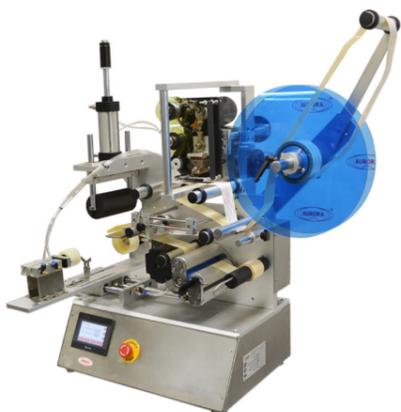
Предназначен для нанесения самоклеящихся этикеток на круглую и квадратную тару.
