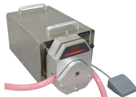
Идеален для промышленного использования и обеспечивает давление при большом расходе, стабильные характеристики потока, низкий шум, легкость в работе. Предназначен для перекачивания различных жидкостей фармацевтического, пищевого и химического назначения.
