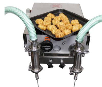
Предназначен для дозированной подачи жидкого, густого и средне-вязкого продукта. Разработан специально для предприятий пищевой индустрии для дозированной подачи кремообразной начинки в заготовки из теста (эклеры, пончики, булочки). За счет универсальной системы розлива может использоваться для наполнения любой тары и применяться не только в пищевом, но и в фармацевтическом, косметическом и химическом производстве.
