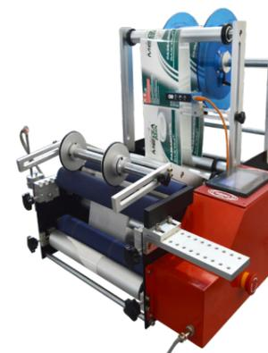
Предназначен для реализации технологической операции этикетирования цилиндрических упаковок: ведер, огнетушителей, флаконов, банок, евробаллонов и других видов тары.
