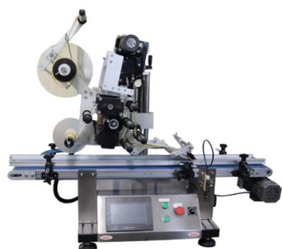
Предназначена для горизонтального нанесения самоклеящихся этикеток на флаконы, пакеты flow-pack и викет-пакеты из полипропиленовой, полиэтиленовой, целлофановой и термоусадочной пленки, а также на тару с плоскими поверхностям.
