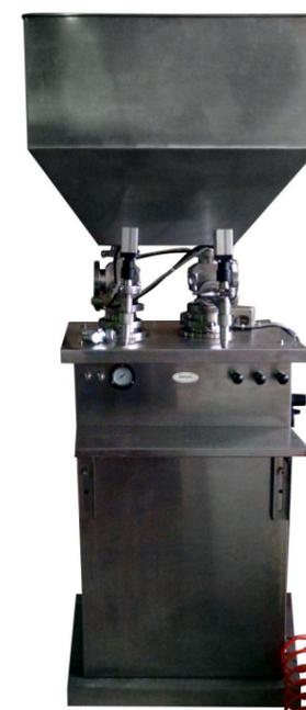
Предназначен для дозированной подачи продукта в ПЭТ-тару объемом 50-500 мл. Сфера применения данного оборудования включает площадки производств косметической, фармацевтической, химической продукции, выпускающих гели для умывания, лечебные мази, моющие средства и другие продукты.
