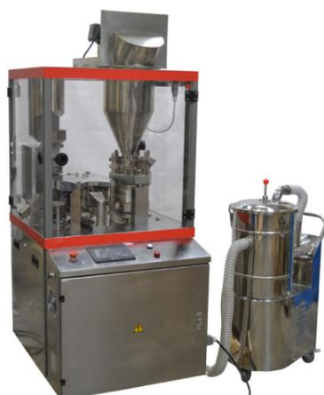
Капсулятор К4-10 предназначен для наполнения желатиновых капсул сухими смесями в виде порошка или гранул. Изделие может применяться на фармацевтических и ветеринарных производствах. Машина автоматически ориентирует капсулы в матрицу, производит раскрытие капсул, фасует порошкообразный материал, закрывает и выгружает капсулы. Система отбраковки позволяет автоматически отсортировать незаполненные или поврежденные капсулы.
