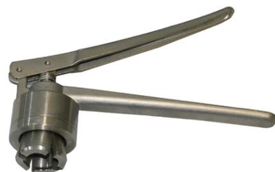
Компактное переносное приспособление ручного типа, для обеспечения быстрой и герметичной закупорки гладких алюминиевых колпачков. При помощи данного устройства можно завальцовывать гладкие алюминиевые крышки. Подходит для стеклянной тары высотой от 20 до 200 мм. Аппарат может быть перенастроен на закупорку крышек различного размера диапазоном от 13 до 34 мм.
