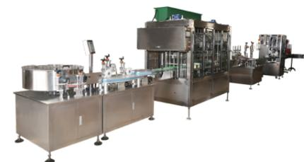
Линия предназначена для дозированной подачи продукта в цилиндрические ПЭТ-флаконы, укупорки колпачками с распылителями/триггерами методом закрутки с заданным моментом и нанесения этикеток из полимерных пленок. Установка может применяться для фасовки бытовых и медицинских антисептических средств, косметической продукции, фармацевтических препаратов (в том числе стерильных), а также широко используется в деятельности компаний химической отрасли.
