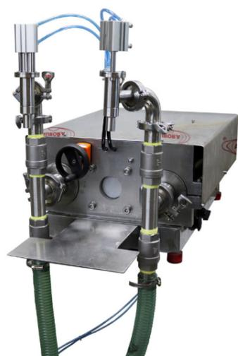
Многоканальная установка, эффективно реализующая процесс дозированного розлива продуктов разной степени густоты и вязкости. Главное отличие установки от базовой модели МД-500Д5 — наличие пневматического привода, работающего без использования электроэнергии.
