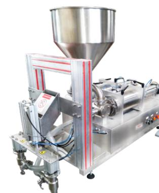
Предназначен для розлива пищевых жидких продуктов и неагрессивных химических веществ в потребительскую тару объемом 5000 мл (канистры, бутылки, мини-бочки).
