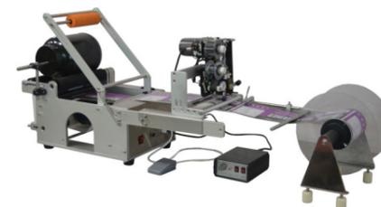
Предназначен для этикетирования продукции, выпускаемой в тубах, флаконах, картриджах, шприцах и любой другой таре цилиндрической и конусообразной формы.
