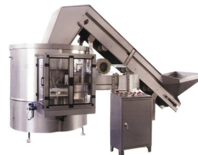
Специализированный комплекс, выполняющий процесс упорядоченной подачи тары в правильном положении и с заданной скоростью. Установка сортирует, позиционирует и распределяет флаконы полностью в автоматическом режиме. Установка оснащена ленточным транспортером, который подает тару в вертикальном направлении от бункера к модулю ориентации. Сфера применения оборудования обширна и включает предприятия, выпускающие пищевую, косметическую, фармацевтическую, ветеринарную и химическую продукцию.
