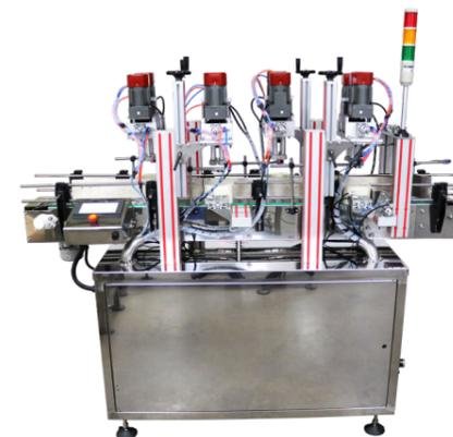
Предназначен для укупорки ПЭТ-тары высотой 200-210 мм колпачками с распылителями и колпачками с триггерами методом закрутки с заданным моментом.
