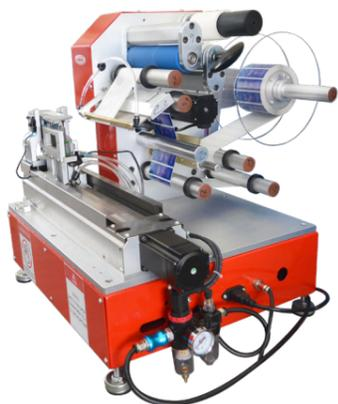
Предназначен для этикетирования силовых, контрольных и других видов кабелей, проводов, жгутов, стержней и других изделий цилиндрической формы этикетками типа «флажок» длиной 10 — 400 мм.
