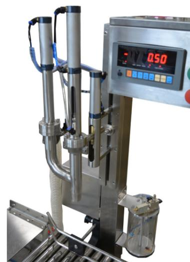
Полуавтоматическая мини-линия розлива «Мастер» с весовым дозатором и укупорочной головкой предназначена для фасовки продукта в ведра и забивки крышек. Установка применяется на предприятиях пищевой, химической, строительной и других отраслей промышленности для фасовки растительных масел, красок, лаков, строительных смесей и другой продукции, выпускаемой в крупногабаритной таре.
