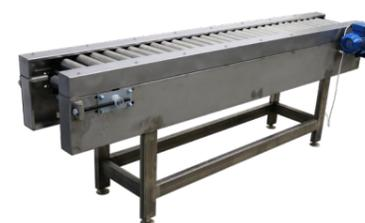
Универсальный конвейер, используемый в составе линейных упаковочных установок. Оборудование востребовано при работе с плоской, ребристой, круглой и другой тарой (картриджи, ампулы, тубы или картуш), которая в силу особенностей формы или легкости веса не может самостоятельно удерживаться на конвейере. Продукция фиксируется в правильном положении в пазах между роликами, что исключает ее падение и сдвиги во время транспортировки.
