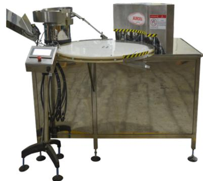
Предназначен для реализации полного цикла укупорки флаконов объемом 2 - 5 мл пенициллиновыми и инсулиновыми металлическими колпачками. Установка может использоваться на участках фасовки и упаковки стерильных и нестерильных лекарственных средств широкого спектра: инсулина, пенициллина, суспензий, инфузионных растворов, лиофилизированных порошков и других твердых и жидких лекарственных форм на спиртовой, водной и масляной основе.
