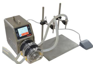
Предназначен для розлива жидких или вязких продуктов в диапазоне от 1 мл до нескольких литров. Конструкция модели исключает загрязнение продукта или насоса, позволяет производить быструю замену дозируемой среды за счет замены шланга, обеспечивает высокую точность розлива. Один конец шланга соединяется с резервуаром подачи продукта. За счет передавливания шланга роликами в дозирующей головке происходит проталкивание жидкости к дозирующему соплу.
